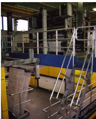
La rotative : elle pèse 400 tonnes et fait 11 m de haut par 40 m de long.
